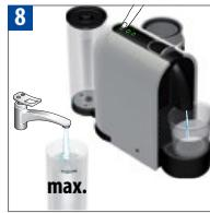
Vacie y aclare cuidadosamente el depósito de agua, el contenedor de cápsulas usadas, la bandeja antigoteo y el soporte para tazas. Llene el depósito de agua con agua potable. Cuando la máquina esté preparada, pulse cualquier botón para aclarar el aparato. La máquina se detendrá cuando esta acción haya concluido.
