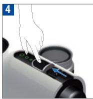
Encienda la máquina mediante la apertura del deslizador. Para ello, desplácelo hacia la parte trasera de la máquina. Luz intermitente en uno de los botones de café: precalentamiento de 25 segundos aproximadamente. Luz fija: la máquina está preparada. La máquina puede pasar al modo de apagado en cualquier momento cuando el deslizador está cerrado si se pulsa cualquiera de los botones durante más de 3 segundos. Esta acción quedará confirmada con el destello de los otros dos botones.
