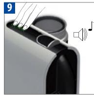
Para salir del modo de descalcificación pulse los tres botones simultáneamente durante más de 3 s. Un sonido breve confirmará esta acción. La máquina está preparada para ser utilizada.
