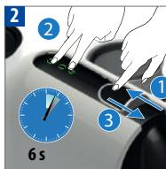
Abra el deslizador. Mantenga pulsados durante más de 6 s los botones Ristretto y Lungo simultáneamente. El otro botón se iluminará. A continuación cierre, el deslizador para iniciar el proceso.
