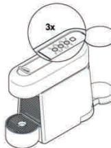
**2 LED ışıklar** makinenin fabrika ayarlarına döndüğünü belirtmek için 3 kez hızlı hızlı yanıp sönenecektir.
