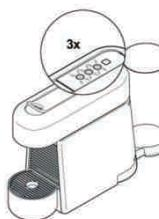
② ไฟ LED จะกะพริบเรื่าง ครั้ง เพื่อยืนยันว่า เครื่องได้รีเซ็ตกลับไปเป็นการตั้งค่าจากโรงงานแล้ว จากนั้นเครื่องจะปิดเองโดย อัตโนมัติ
