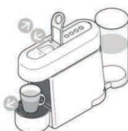
**5 Fincanı çıkarın.** Kapsülü, kullanılmış kapsül kabına aktarmak için kolu kaldırın ve kapatın.
