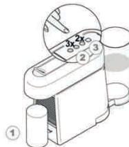
**7 Makineyi durulamak için, kahve çıkış ağzının altına bir kap koynun (en az 1 L kapasite). Lungo butonuna basın. 3 kez tekrarlayın. Sicak su butonuna basın. 2 kez tekrarlayın.**
