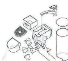
❶ เท่านี้ในการล้างน้ำ ฐานรองน้ำ และแคปซูลในช่องเก็บแคปซูลให้แล้วให้หมดเป็นประจุทุกวัน และถอดถังบรรจุน้ำพักผ่อนฝ่าอกมาทำความสะอาดโดยใช้น้ำยาล้างจานแบบไว้กลิ่น และล้างด้วยน้ำอุ่น/ร้อน
