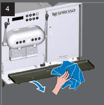
Schwarze Kunststoffschale herausnehmen und mit Seifenwasser reinigen.
