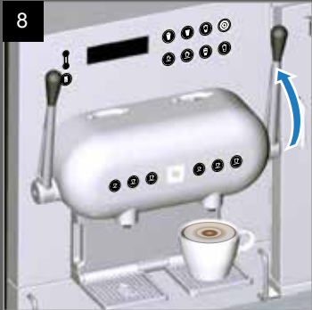
La cápsula usada se expulsa subiendo la palanca.
