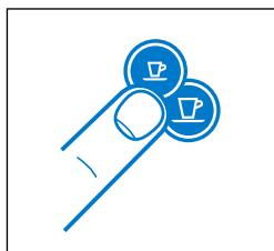
5. Apăsați butonul Espresso (40 ml) sau Lungo (110 ml) pentru a porni. Prepararea se va opri automat. Pentru a opri fluxul de cafea sau pentru a vă completa cafeaua, apăsați încă o dată.
