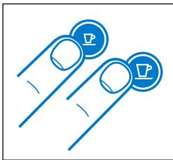
5. Pentru a intra în modul de detartrare, în timp ce aparatul este pornit, apăsați simultan butoanele Espresso și Lungo, timp de 3 secunde.
