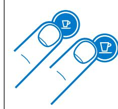
For at slukke maskinen inden automatisk sluk-funktion ved at trykke på både Espresso- og Lungo-knappen samtidig.
