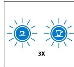
2. LED-lamperne vil blinke hurtigt 3 gange for at bekræfte, at maskinen er nulstillet til fabriksindstillingerne.
