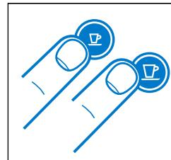
Pentru a opri aparatul înainte de intrarea în modul Power Off (oprit), apăsați simultan butoanele Espresso și Lungo.
