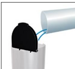
7. Reumpleți rezervorul de apă cu soluția de detartrare utilizată colectată în recipient și repetați pașii 4 și 6.
