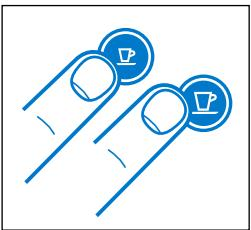
5. För att gå till avkalkningsläget, tryck in båda Espresso- och Lungoknappen i 3 sekunder när maskinen redan är påslagen.
