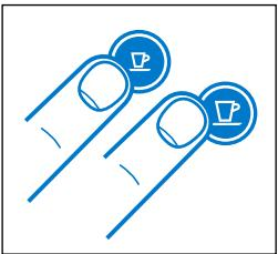
5. Mens maskinen er tændt, kommer du ind i afkalkningsprogrammet ved at trykke på både Espresso- og Lungoknappen i 3 sekunder.
