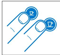
10. Pentru a ieși din modul de detartrare, apăsați simultan butoanele Espresso și Lungo timp de 3 secunde.
