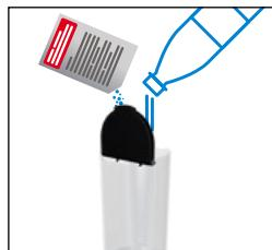
3. Umpleți rezervorul de apă cu 0,5 L de apă potabilă și adăugați lichidul de detartrare Nespresso.
