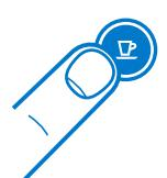
3. Jos haluat muuttaa tästä asetusta paina Espresso-painiketta: Yhden kerran, jos haluat asettaa energiansäästötilan 9 minuutin jälkeen Kaksi kertaa, jos haluat asettaa energiansäästötilan 30 minuutin jälkeen
