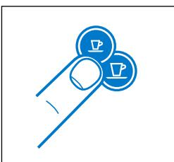
5. Tryk på Espresso-knappen (40 ml) eller Lungo-knappen (110 ml) for at starte maskinen. Brygningen stopper automatisk. Tryk én gang mere for at stoppe kaffestrommen eller fylde mere i koppen.
