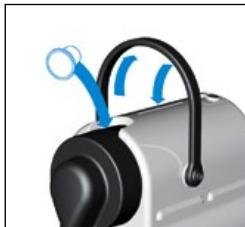
2. Umpleți rezervorul de apă cu apă potabilă și inserați capsula.
