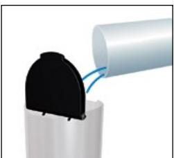
7. Fyld den brugte afkalkningsopløsning, som er opsamlet i beholderen, tilbage i vandbeholderen, og gentag trin 4 og 6.
