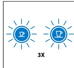
2. LED-urile clipesc rapid de 3 ori pentru a confirma resetarea la setările din fabrică.
