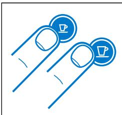
1. Du kommer ind i tømningsprogrammet ved at trykke på både Espresso- og Lungo-knappen for at slukke for maskinen.
