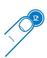
3. Tryk på Espresso-knappen for at ændre denne indstilling: Én gang for at maskinen slukker automatisk efter 9 minutter
