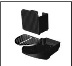
2. Töm droppbrickan och behållaren för använda kapslar.
