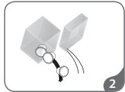
Αδειάστε τον κάδο για το χρησιμοποιημένο νερό καθώς και τον κάδο συλλογής χρησιμοποιημένων καψουλών. • Vyprázdněte nádobu na kapsle a odkapávací misku.
