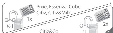
Fyld vandbeholderen med Nespresso afkalkningsmiddel og vand
