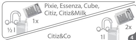
Llene el depósito de agua con agente descalcificador Nespresso y agua (Citiz&Co: descalcificar ambos cabezales simultáneamente). Encha o depósito de agua com produto descalcificante Nespresso e água (Citiz&Co: descalcifique ambas as cabeças em simultâneo).
